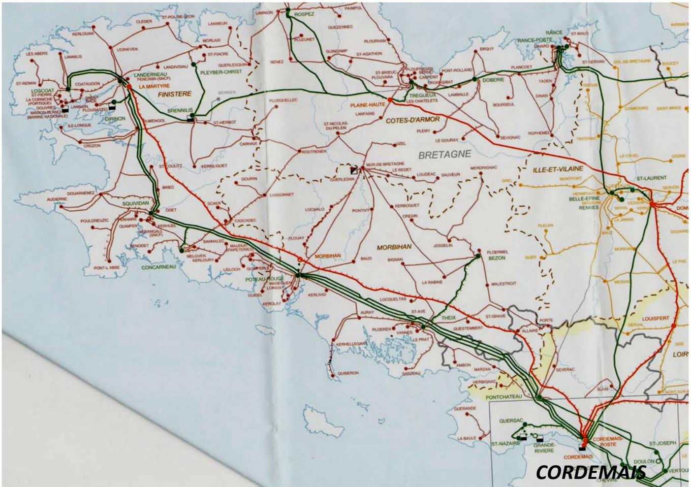
Les lignes rouges représentent les liaisons à 400 KV et les lignes vertes les liaisons à 225 KV.
