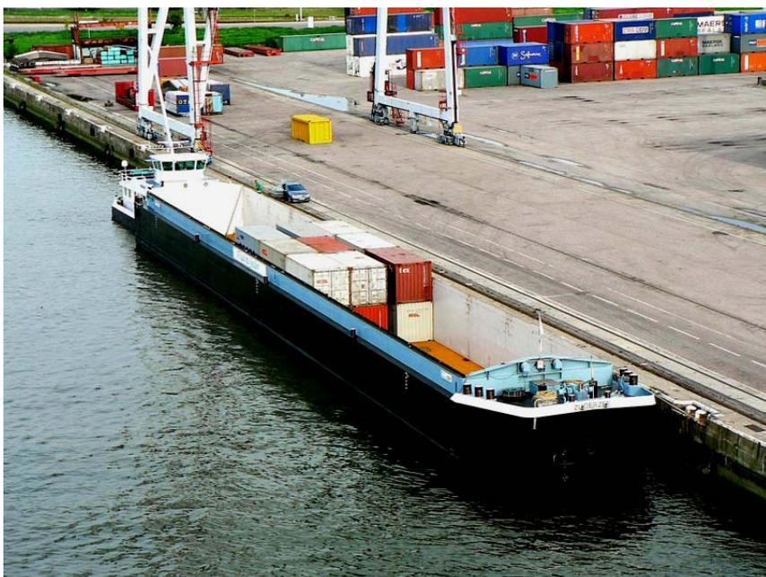
Sur la Seine : un exemple de système intermodal pour le transport fluvio-maritime des conteneurs. Plusieurs opérateurs desservent la liaison Le Havre-Rouen-Gennevilliers. Chaque unité fluviale peut transporter, en gros, de 100 à 350 EVP suivant qu'il s'agit d'un automoteur ou d'un convoi poussé.
