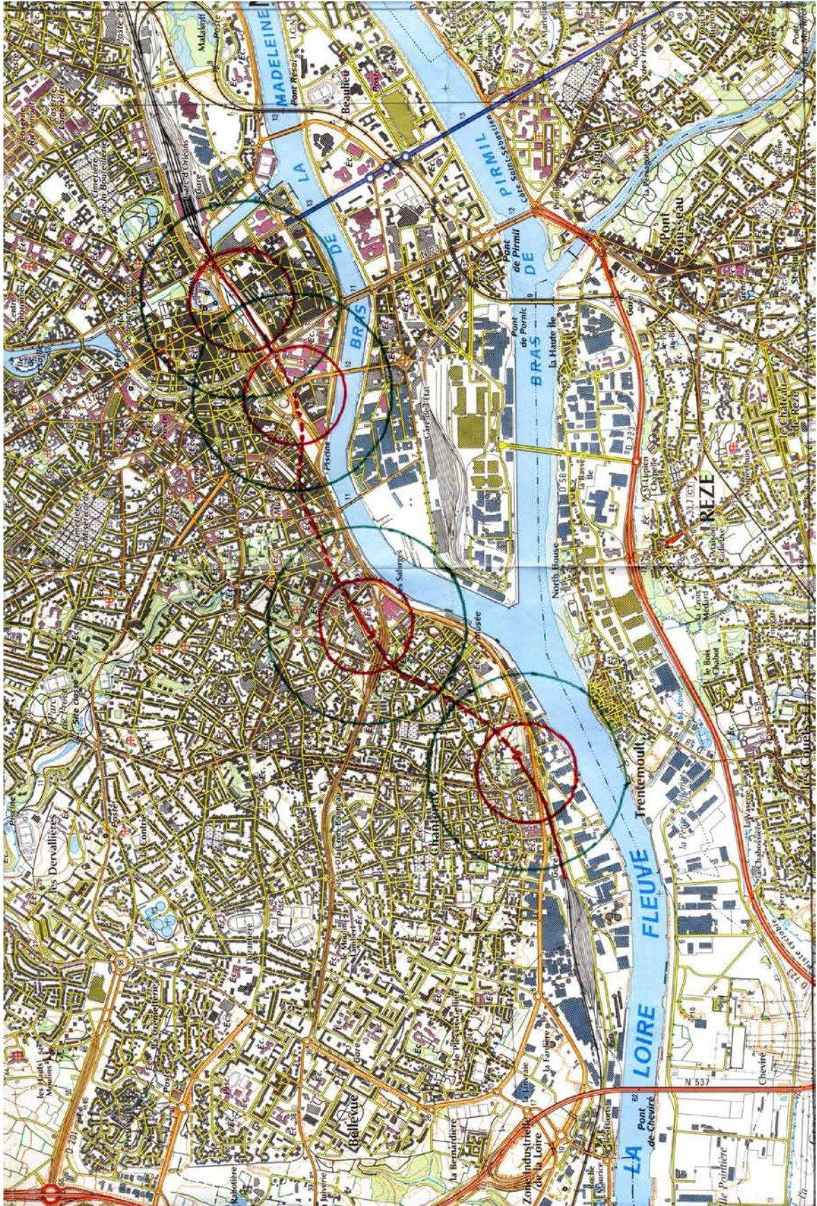
Le parcours du tunnel de Chantenay et les zones pouvant être impactées par un sinistre majeur. (En rouge r=300m BLEVE simple. En vert r=600m , BLEVE avec "missiles").
