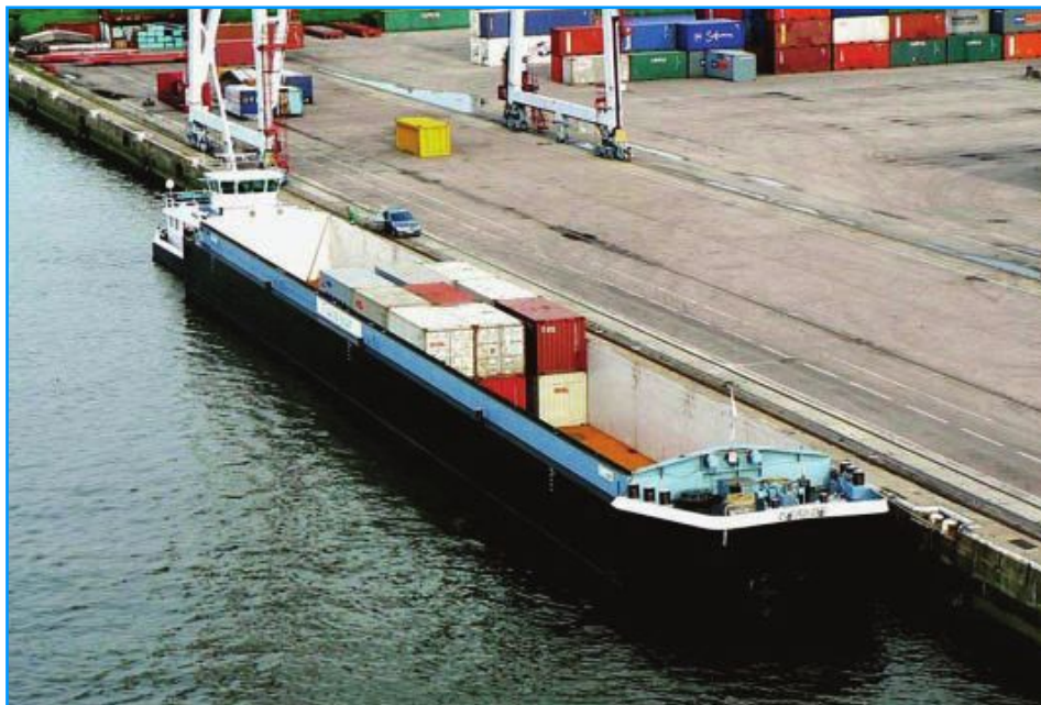
Sur la Seine : un exemple de système intermodal pour le transport fluvio-maritime des conteneurs. Plusieurs opérateurs desservent la liaison Le Havre-Rouen-Gennevilliers. Chaque unité fluviale peut transporter, en gros, de 100 à 350 EVP suivant qu'il s'agit d'un automoteur ou d'un convoi poussé.
